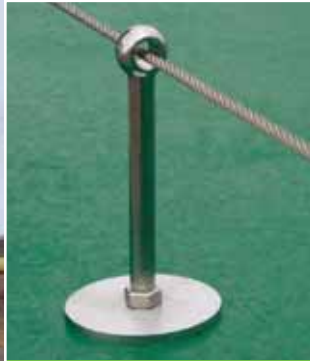
Augenschrauben als Abstandhalter mit Wandabstand 9 cm für geringe Belastung
